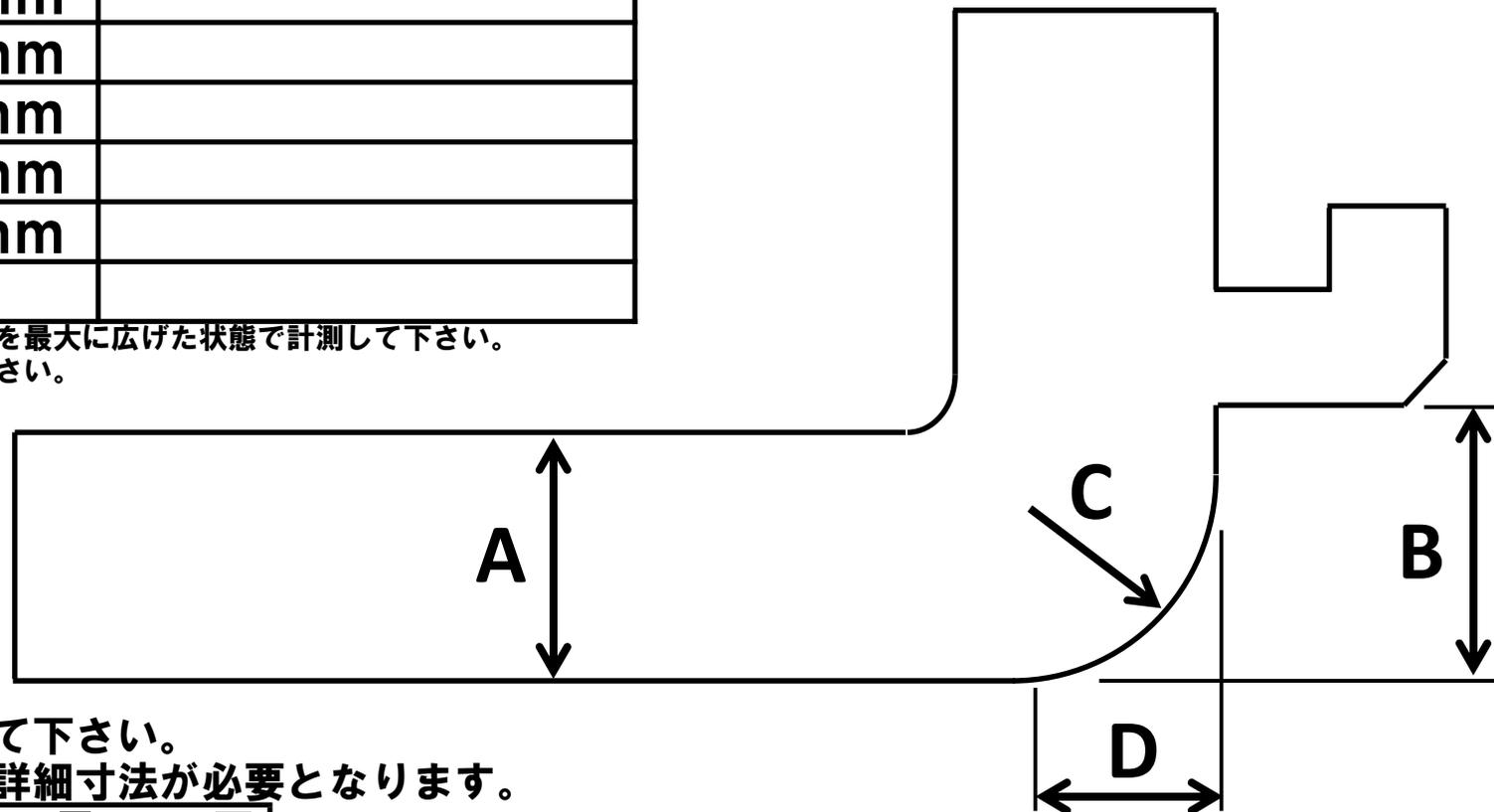
※ピッチ寸法は元爪間（左右元爪の間隔）を最大に広げた状態で計測して下さい。
